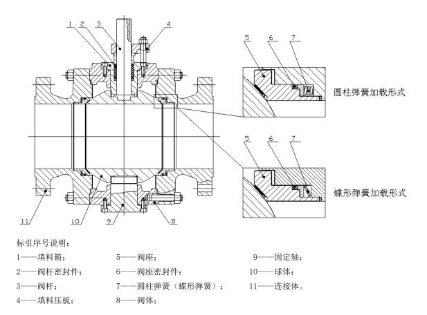
图2 法兰连接固定球球阀典型结构
